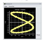
Das XY Modul zeigt Lissajous-Figuren. Das sind Graphen, die durch die Überlagerung zweier rechtwinklig zueinander stehender harmonischer Schwingungen entstehen. Die Form der Figuren erlaubt genaue Rückschlüsse auf Frequenz und Phasenlage der beiden Spannungen.
