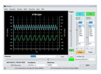
Das Modul stellt grafisch das gemessene AC Signal der beiden Soundkarteneingänge dar. Über die Zeitbasis stellen Sie die Skalierung für die x-Achse und über den Spannungsbereich die der y-Achse ein.
