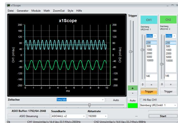
Das Modul stellt grafisch das gemessene AC Signal der beiden Soundkarteneingänge dar. Über die Zeitbasis stellen Sie die Skalierung für die x-Achse und über den Spannungsbereich die der y-Achse ein.
