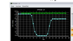
Das Modul "yt-Logger" (Datalogger) übernimmt zyklisch die Messwerte aus CH1 und / oder CH2 (Urms oder Frequenz) und fügt sie der Messkurve des Datenloggers hinzu. Die Taktrate beginnt bei 1 Sekunde.
