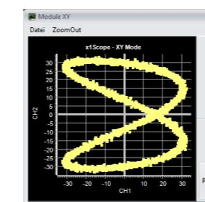
Das XY Modul zeigt Lissajous-Figuren. Das sind Graphen, die durch die Überlagerung zweier rechtwinklig zueinander stehender harmonischer Schwingungen entstehen. Die Form der Figuren erlaubt genaue Rückschlüsse auf Frequenz und Phasenlage der beiden Spannungen.
