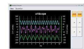
Gespeicherte Diagramme vom Oszilloskop, FFT Modul, YT Modul und XY Modul können Sie mit dem Active Viewer später betrachten. Mit der Mausgeste können Sie in die Grafik hinein zoomen, einzelne Kanäle ausblenden oder über die Pfeiltasten horizontal verschieben.
