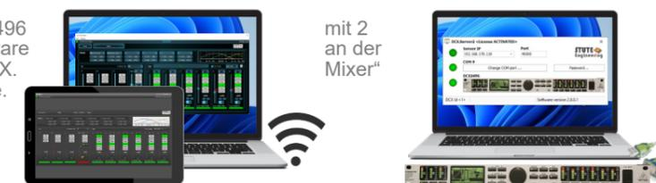
**Mode „Direkt“:** Steuerung der DCX2496 mit einem PC, z.B. im Studio die DCX2496 Settings vorbereiten. DCX.Mixer / DCX.Client sowie DCX.Server Software sind auf dem gleichen PC installiert.
