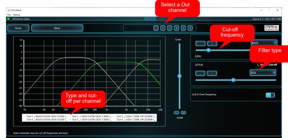
Steuerung der Grenzfrequenzen, Filtertypen und Verzögerungen für die Ausgänge 1 bis 6.
