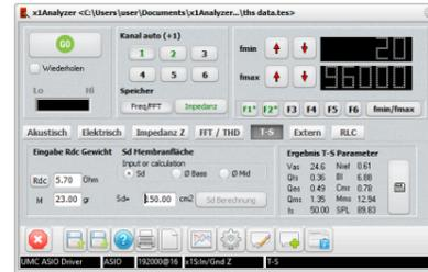
**Tipp: Speichern Sie die T-S Messung. "Rdc", das Gewicht der Zusatzmasse und die effektive Membranfläche "Sd" werden als Notiz mitgespeichert. Eine spätere Neuberechnung aus den Messdaten und der Eingabe der Daten aus der XY Kopfzeile sind so einfach möglich**
