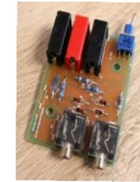
Zur Messung der Impedanz oder des elektrischen Frequenzgangs der Frequenzweiche sowie zur vollständigen Systemkalibrierung wird ein einfacher Adapter benötigt. Der Adapter benötigt keine Stromversorgung.
